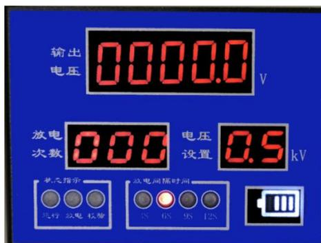
正常开机后如 5 分钟之内无任何操作则仪器会自动关闭，以节约电池电量。
